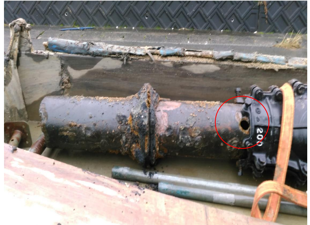
老朽化により穴が開いた鋳鉄管
