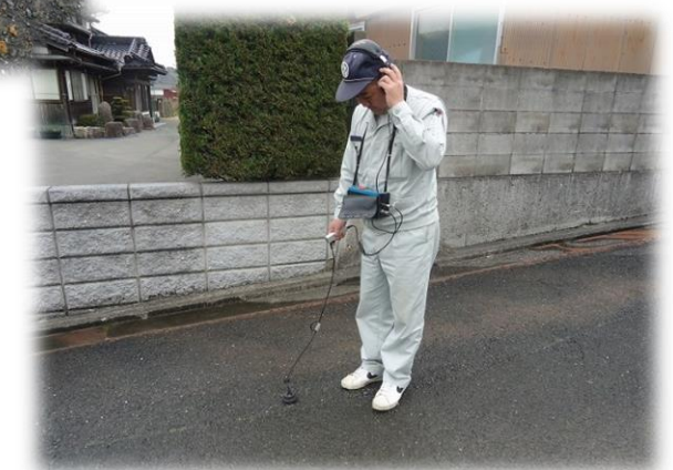
漏水調査の様子
